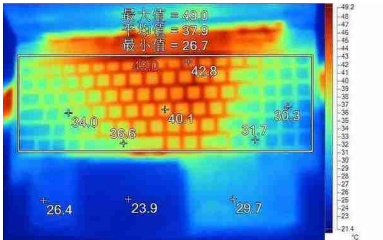
检查风扇是否灰尘过多造成风扇转速慢或停转，建议定期清理风扇和PCB表面的灰尘。
