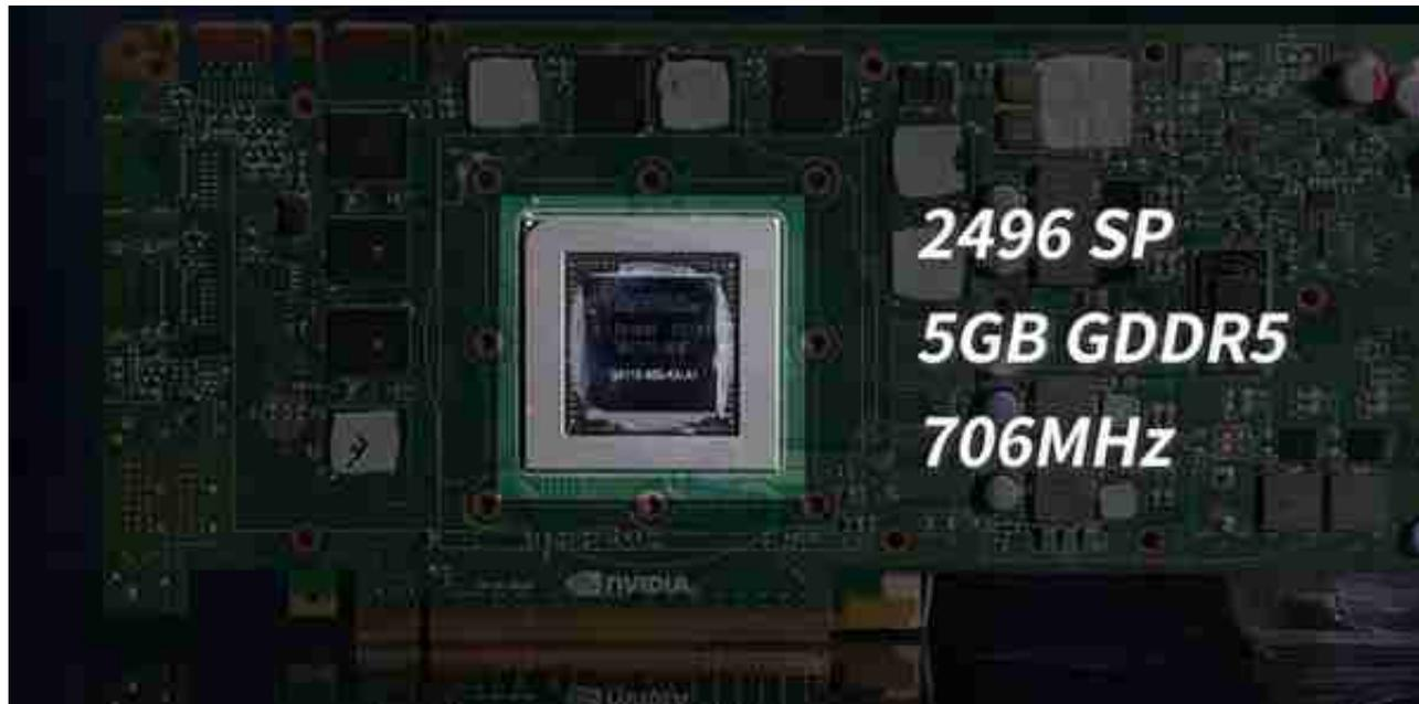
两者硬件规格没有区别，都采用 GK110 核心，拥有 2496 个流处理器，辅以 5GB GDDR5 显存，核心频率 706MHz，其规格非常接近游戏卡 GTX TITAN，可惜它是一张纯计算卡，没有视频输出，那它有机会改成 TITAN 吗？
